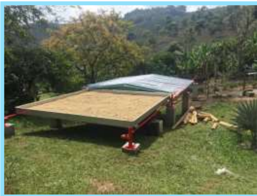
Coche secador solar sistema automático (para entrega en febrero de 2020)
